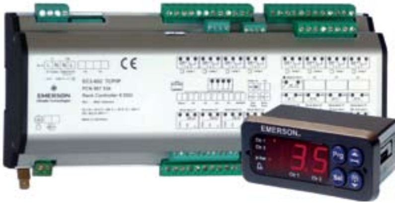
■ Figure 10 Modèles de régulateurs EC3 pour les centrales frigorifiques de supermarchés. Ils peuvent gérer jusqu'à 8 compresseurs ou jusqu'à 7 standards + 1 compresseur Digital
