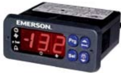
■ Figure 7 Un modèle de régulateur EC2 caractérisé par un afficheur à LED avec deux chiffres et demi, 4 LED indicateurs, clavier à 4 touches, récepteur de la télécommande à infrarouge en option, ainsi que la possibilité de gestion à distance et d'installation en réseau.
