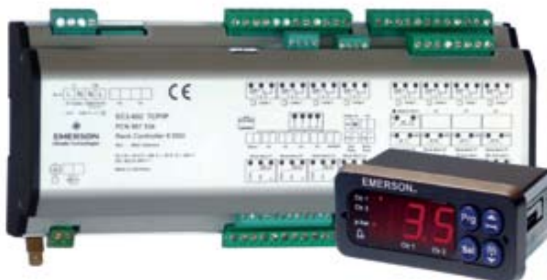
■ Figuur 10: Rackbediening EC3-65x voor supermarkten die tot 8 enkelvoudige compressors of tot 7 enkelvoudige compressors + 1 Digital Scroll™-compressor kan beheeren.
